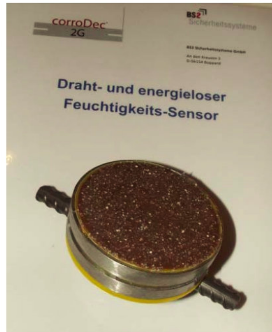
Type C – Feuchtigkeits-Sensor
